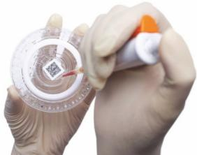
Цельную кровь, сыворотку или плазму помещаем в центр реакционного диска
