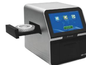
Помещаем диск с образцом в анализатор и запускаем тестирование
